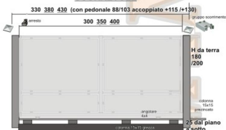
Per l'installazione con colonne a rivestire (calcolate 38x38 cm) le strutture si realizzano con pali tubolari in acciaio grezzo da 12x12 cm aventi i cardini di ancoraggio distanziati opportunamente di 13 cm dai pali stessi. Gli ingombri esterni dei pali (escluso l'ulteriore rivestimento esterno) rispetto alle misure sopra indicate sono da calcolare aggiungendo cm 20 sui due pali (luce cancello), e 43 cm su tre pali (cancello + pedonale)
